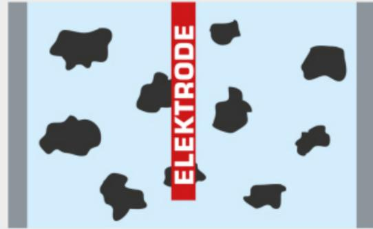
**02** Durch eine Hochspannungselektrode werden Elektronen freigesetzt.
