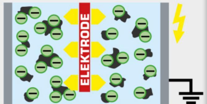
**04** Der Feinstaub sammelt sich an der Kaminwand an und agglomeriert zu groben Flocken. Diese Ablagerungen werden bei der Reinigung durch den Kaminfeger entfernt.
