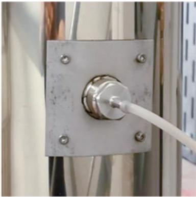
**7.** Anschluss-Stutzen für Unterdruckschlauch anbringen
