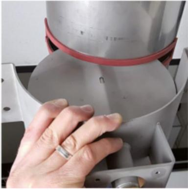
**4.** Nach dem zusammensetzen der Klappe und der Halbschale mit Motoraufnahme, kann die Klappe durch die Einbauöffnung in das Abgasrohr geschoben werden
