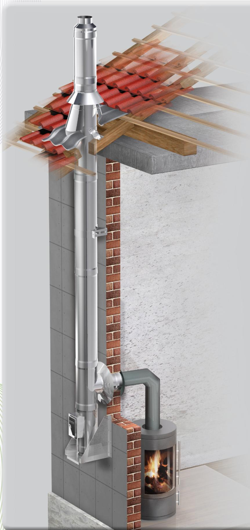
Der große Vorteil des Future Doppelwandsystems besteht darin, dass für die Verbindungen im senkrechten Teil untereinander keine Schellen oder Dichtungen erforderlich sind.
